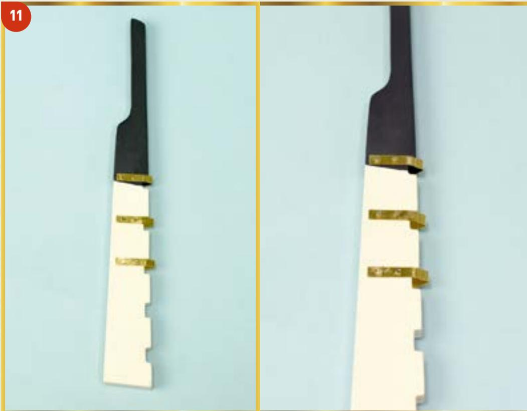
**11** Таким же образом приклейте к рулю третью петлю и закрепите в ее отверстиях гвоздики.
