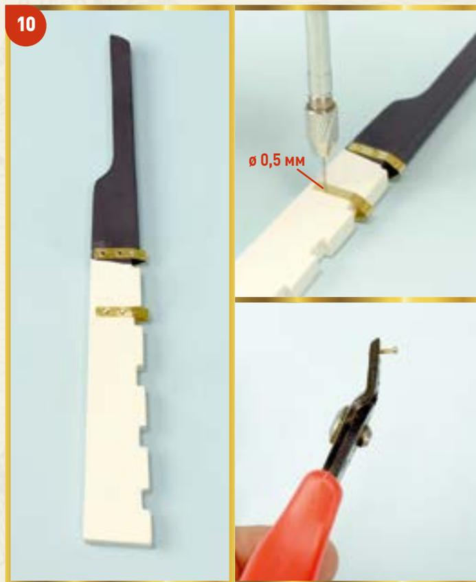
**10** Аналогичным образом приклейте на руль вторую петлю. Затем, используя ручную дрель со сверлом диаметром 0,5 мм, просверлите в руле отверстия, которые соответствуют отверстиям в петлях. Вставьте в эти отверстия по гвоздику: для этого предварительно обрежьте гвоздики до длины не более 1,5 мм и нанесите на них немного клея.
